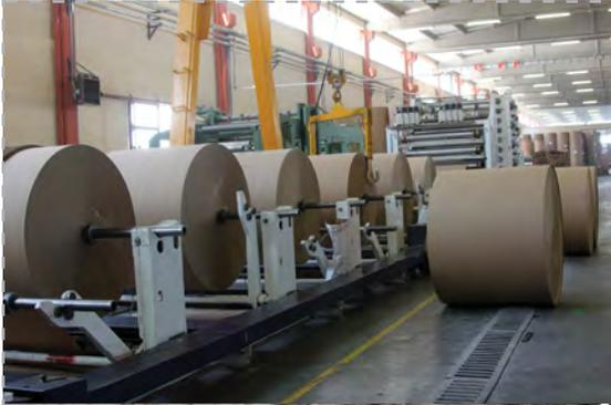
En la planta de ensamblaje de bolsas, una máquina para hacer sacos corta rollos de papel en hojas.
