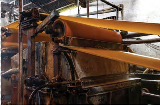
La mezcla de pulpa se mueve a través de una serie de rodillos que la presionan y la secan en rollos de papel.
